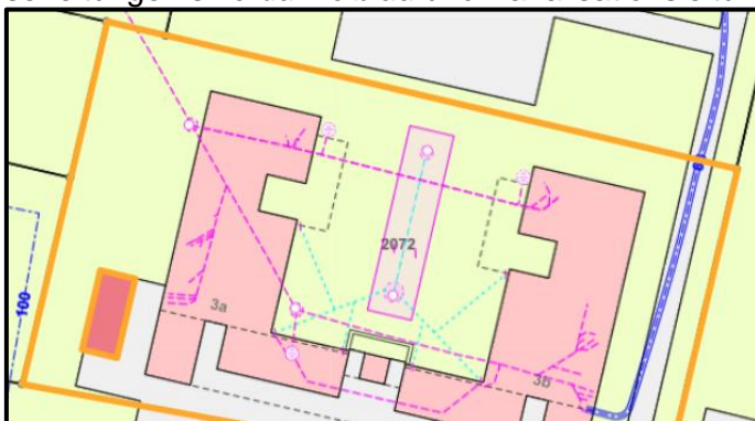
Abbildung 2: Auszug aus dem Leitungskataster des GIS BL zu Parzelle Nr. 2072 (Wasserleitungen sind dunkelblau und Kanalisationsleitung pinkfarben dargestellt).
